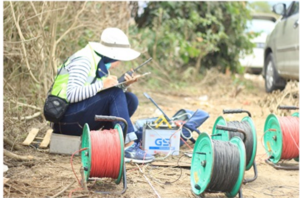
Gambar 6 Penyelidikan Geofisika Menggunakan Metode Geolistrik Daerah Terdampak Likuifaksi Sibalaya
