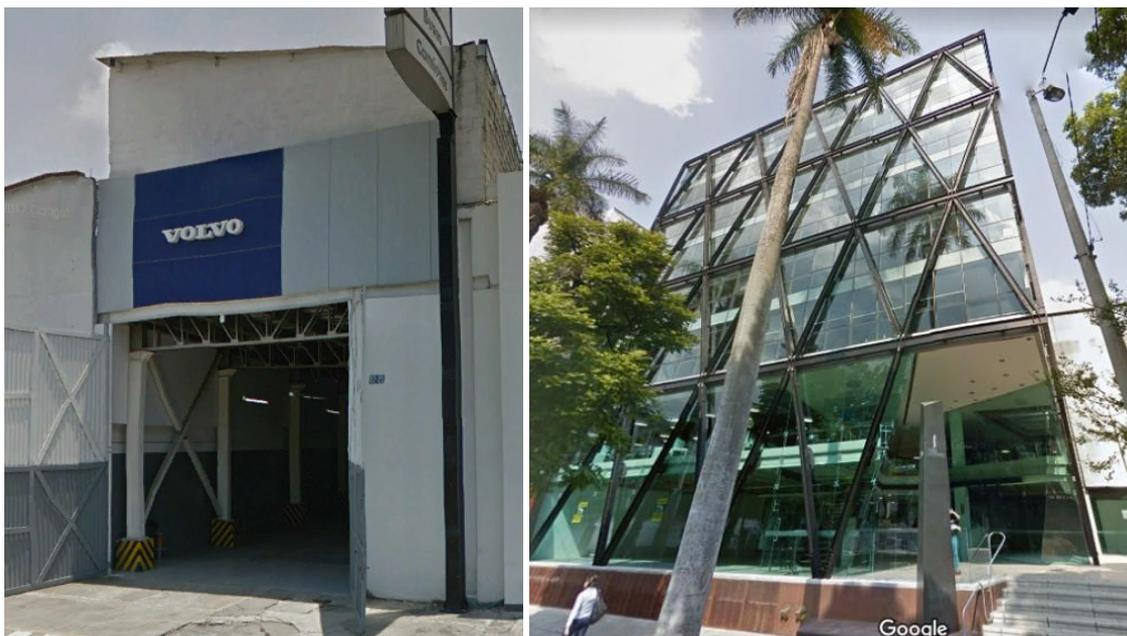
**Figura 21. Bodega en la calle 32 y edificio en el barrio Centenario construidos en pórticos de acero arriostrados.. Tomados de OSSO (2017).**
