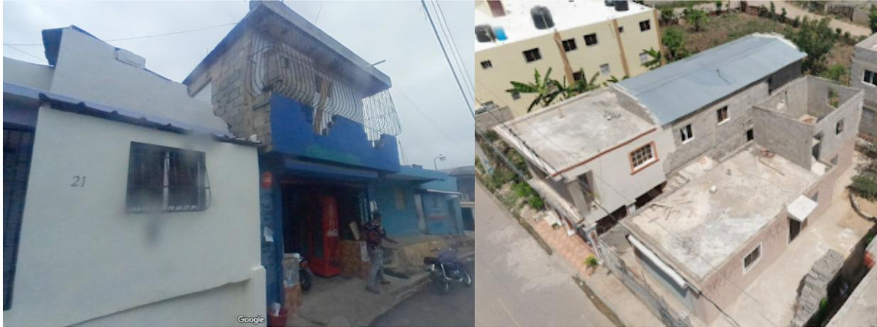
**Figura 28. Casa de mampostería sin confinamiento ni refuerzo visible en el proceso constructivo. Tomadas de Google Maps (2020) y el Plan de Acción de Santiago (BID 2015).**
